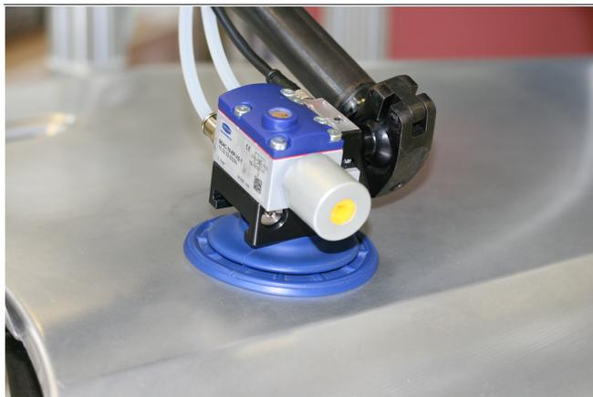
Generazione di vuoto decentralizzata mediante eiettori con dispositivo di sgancio SEAC RP direttamente sulla ventosa
